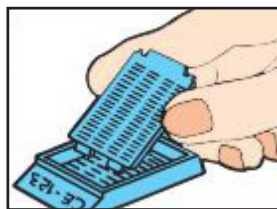
mise en place du couvercle et verrouillage
