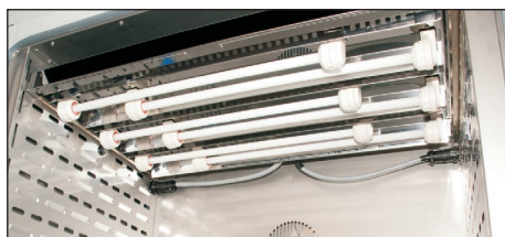
3 panneaux d'éclairage verticaux placés dans la porte et le long des parois latérales, avec vitres de protection
