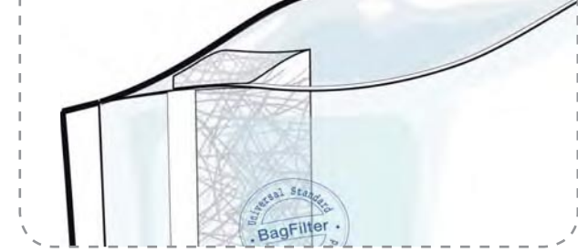
Filtre latéral, idéal pour les échantillons fibreux
