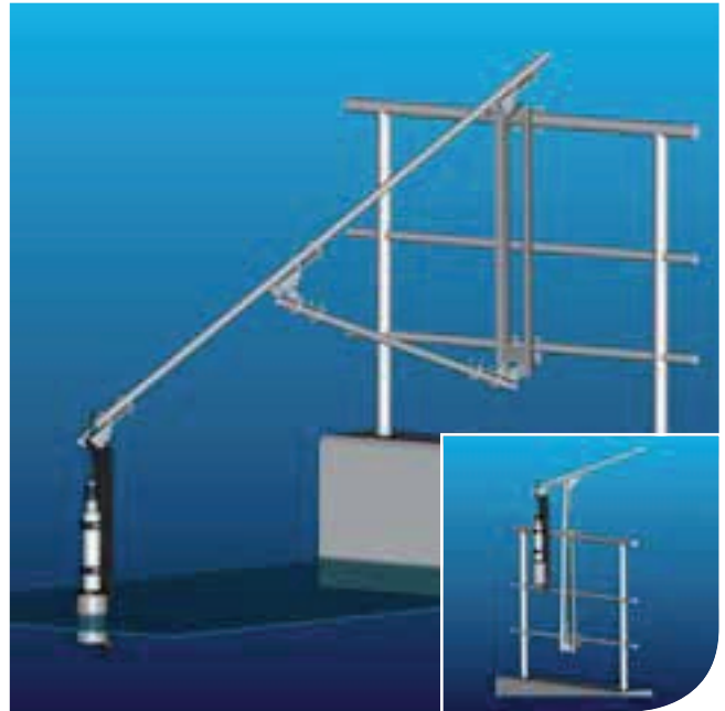
Emploi de l'armature rabattante IFL-D avec le système de montage sur rambarde IFL-RM pour racleurs de surface mobiles.
